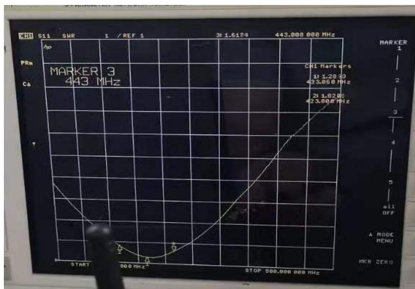
天线出厂前都经过网络分析仪在无线数据传输系统模拟环境下的严格检定。
